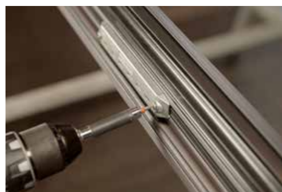
Poinçonnage direct de la tige de crémonne
